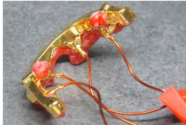
Abb. 18: Nach dem Galvanisierungsprozess
