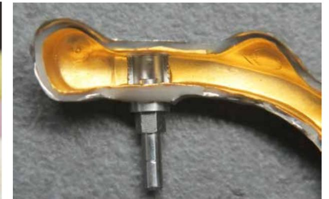
Abb. 37: MK1-Attachment geöffnet
